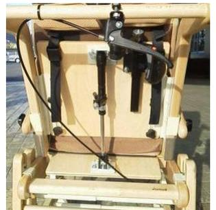
「コパン」は基本的にチルト機構のついたフレームです。それに追加して「背もたれ」だけが単独でリクライニングできるようにしてみました。しかも、チルトの軸にリクラの軸を重ねてみたところ上手く「生体軸」に近いところで倒れることができ、クッションの中で身体がずれにくいようになっています。リクラのメカロックは座板と背板に直接固定しました。
