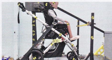
4輪フレームで支えられたシャトルディスカバリーは、車での安全な移動のために車載安全基準である [ISO 7176-19] に準拠しております。
